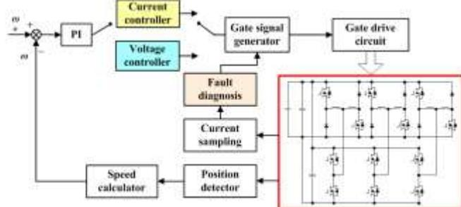
(d) Diagram of the fault tolerance control system
